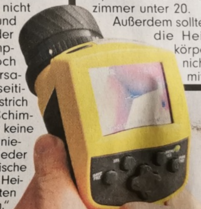
▲ Mit einem Schimmel-Detektor können Experten gefährdete Stellen entdecken
